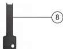
**HERRAMIENTA DE EXTRACCIÓN DE VÁLVULAS DE RETENCIÓN DE LA SIERRA PRINCIPAL SUPERCUT**
