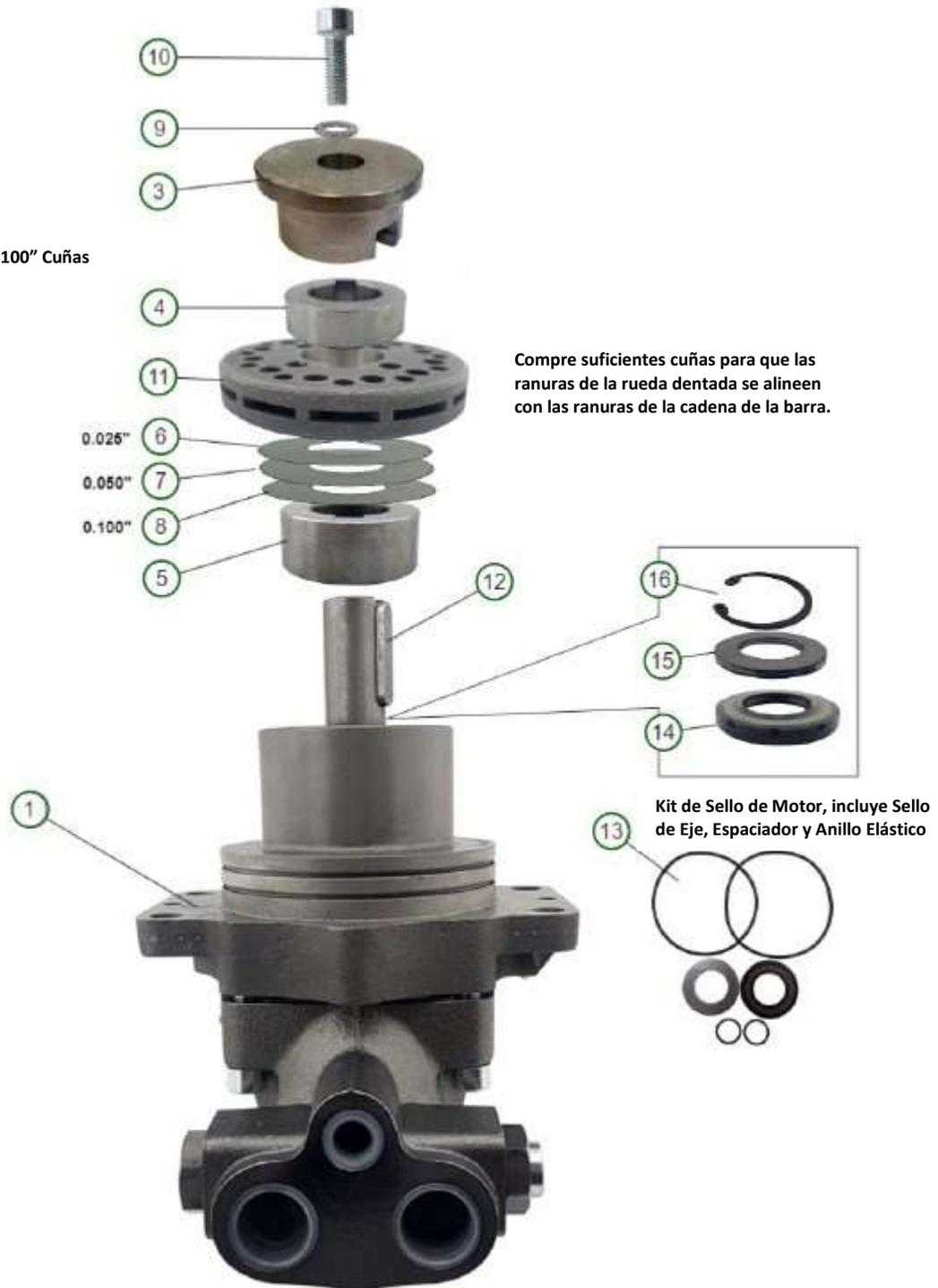
Compre suficientes cuñas para que las ranuras de la rueda dentada se alineen con las ranuras de la cadena de la barra.
